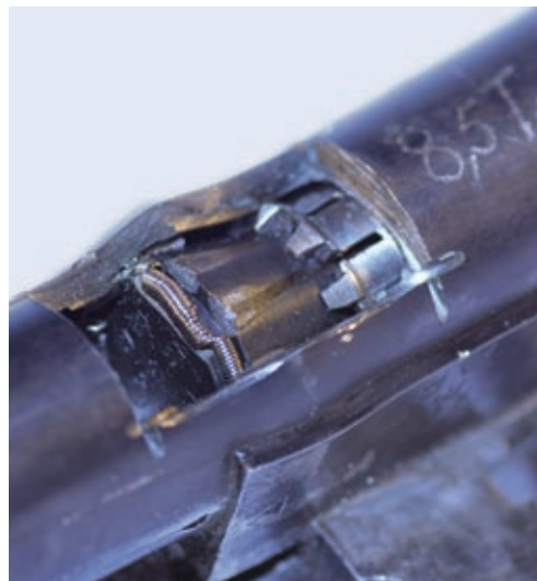
KAMMERLÅS AMLOCK UDSAT FOR PRES PÅ 8,5 TONS
